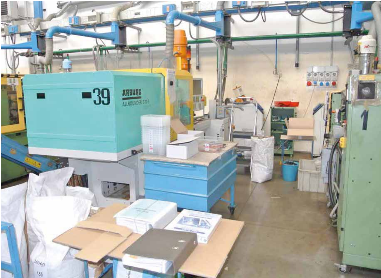
Código: 15011 detalhe da prensa a injeção para fabricação do tijolinho semelhantes àqueles das construções com LEGO
