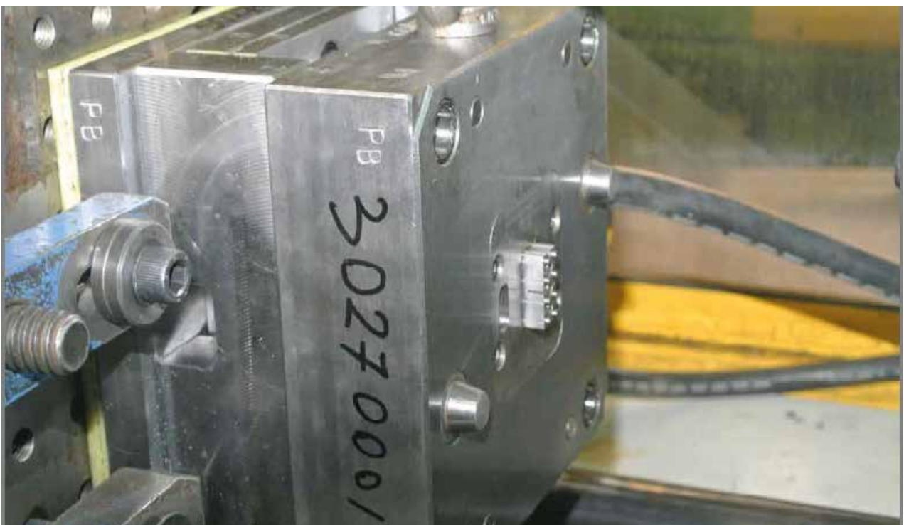
Código: 15010 detalle lateral del molde para piezas del tipo de las construcciones LEGO
